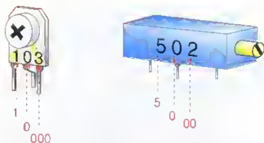
Figura 6.19. Código numérico para la identificación de los potenciómetros
